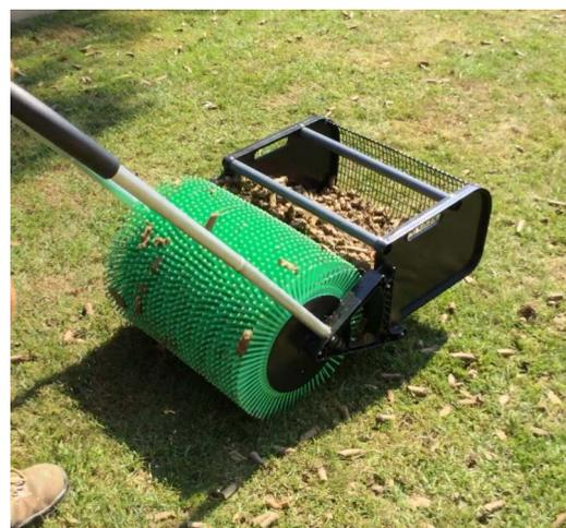
In einem zweiten Arbeitsgang werden die Erdkerne mit einem speziellen Aufsammler entfernt.
